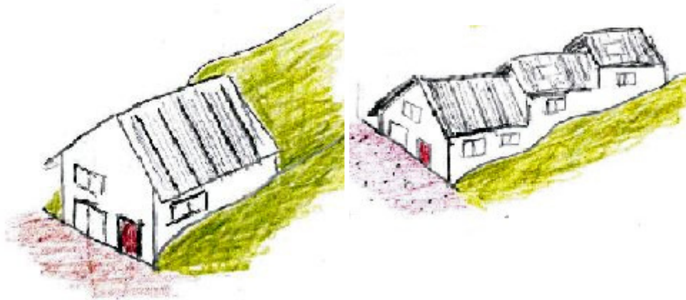
Principe d'intégration dans la pente. (tdu)
